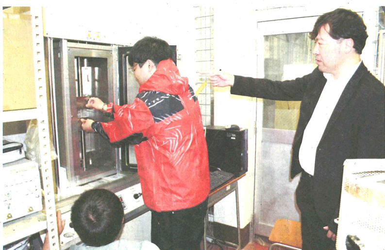
実験器具を使い、ポリ乳酸とバイオポリエチレンを混ぜた素材の柔軟性を確かめる信山克義教授(右)と研究室のメンバー=5月15日、八戸工業大
